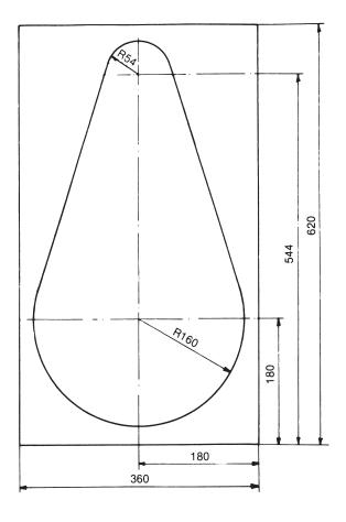
Ramme av 10 mm sponplate (eller kryssfiner) for stoff Frame made of 10 mm chipwood (or plywood) for fabric Rahmen aus 10 mm Sponplatte (oder Sperrholz) für Bespannstoff Baffle en 10 mm contreplaqué ou aggloméré
